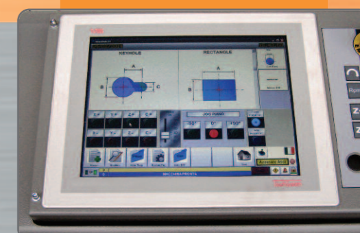
CNC TS7005 Touch-screen con ethernet per diagnostica e chiavetta USB
